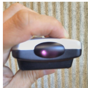
写真①：送信部に赤外線が光っているのがわかる。
